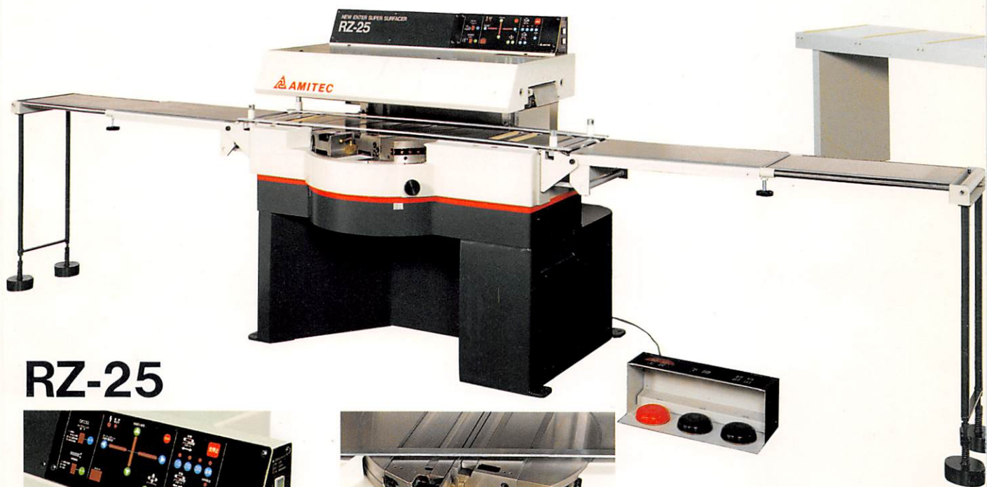
★材質に合わせ、刃物切削角度が選べる ダブルスーパーナイフストック付回転テーブル
