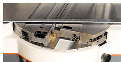
★材質に合わせ、刃物切削角度が選べる ダブルスーパーナイフストック付回転テーブル
