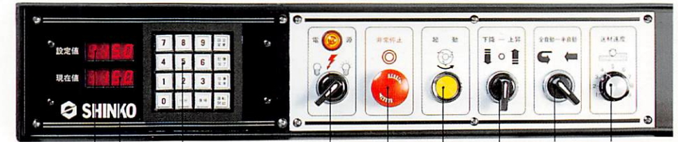
●操作盤名称 ①設定値表示部 ②現在値表示部 ③テンキースイッチ ④電源スイッチ ⑤非常停止ボタン ⑥起動スイッチ ⑦手動上下スイッチ ⑧送材切換スイッチ ⑨送材速度調整ダイヤル
