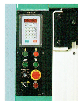
「コンベア無しタイプ」前面操作パネルは機械本体に組み込み式です。
