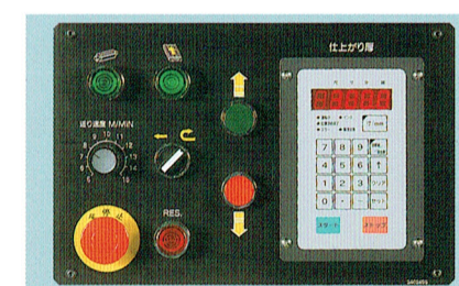
仕上げ加工厚さを自動位置決め装置・数値入力後スタートで、所定寸法になります。デジタル表示も寸・ミリの使い易い表示に瞬時切換可能です。
