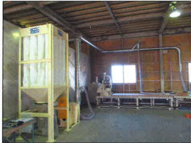
窯業系サイディング切断屑集塵:KBF-3.7(3.7kw) 「フィルター特殊仕様」
