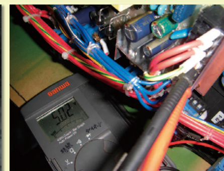
シンクス製全自動製パネルソー基盤内部の部品取替
