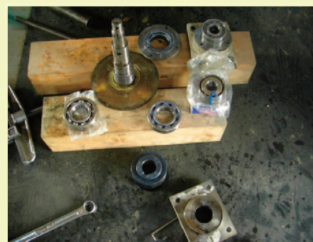
アミテック製ランニングソー主軸ベアリングの交換
