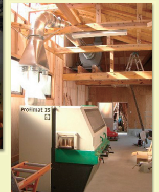
ヴァイニッヒ製モルダー用集塵システム (福島県 製材・工務店様)
