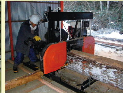
ハスクバーナ製簡易製材機(スウェーデン) (長野県国立大学様へ導入)
